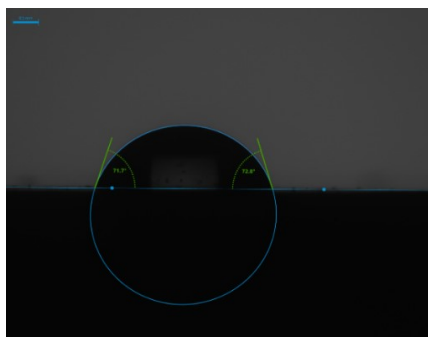
Рисунок 5.2 – Зовнішній вигляд краплі дистильованої води, що сидить на поверхні зразків до (а) і після плазмової обробки (б)
