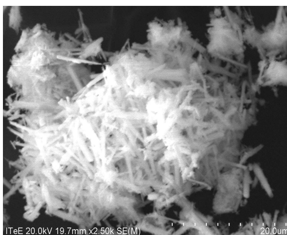
Рисунок 3.18 – Мікроструктура зразка складу \text{ZrO}_2 - 15 \text{ мас.}\% \text{ CeO}_2 ( \times 2500 )
